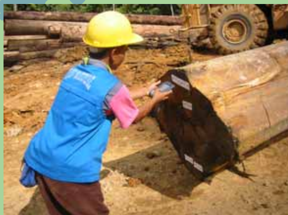
ラベルをスキャンして丸太情報の 入手と搬入搬出丸太の登録
