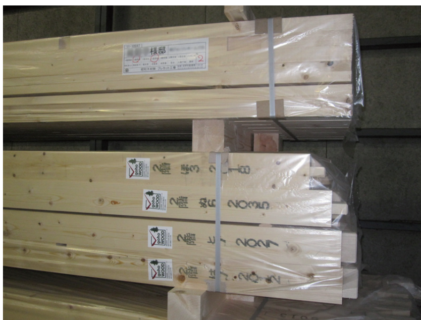
写真 2（1）1 ラベリングの後梱包されたプレカット材
