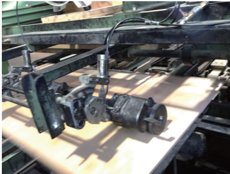
写真2 (20) 2 流れる合板にローラーで印字する
